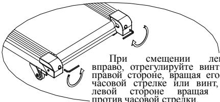
При смещении ленты вправо, отрегулируйте винт на правой стороне, вращая его по часовой стрелке или винт, на левой стороне вращая его против часовой стрелки.
