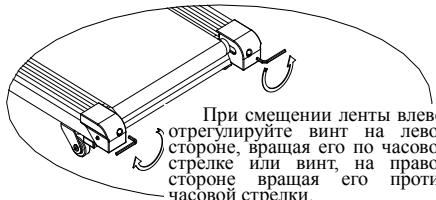
При смещении ленты влево, отрегулируйте винт на левой стороне, вращая его по часовой стрелке или винт, на правой стороне вращая его против часовой стрелки.
